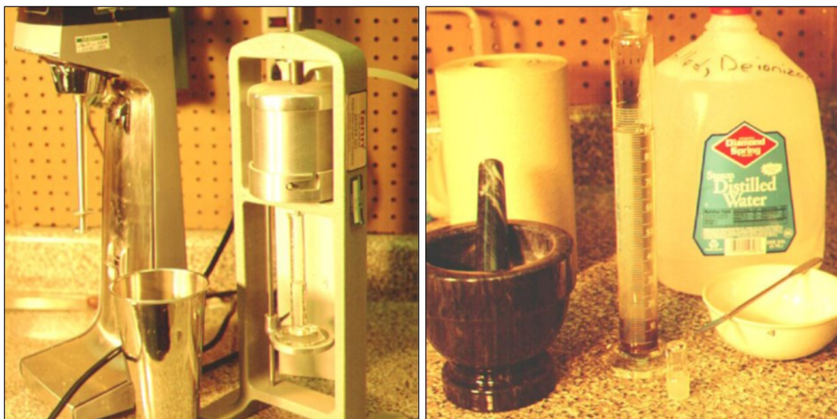
شکل ۲-۸- آزمایش‌های بنتونیت بر اساس GRI-GCL3: بنتونیت در یک استوانه مدرج جهت اندازه‌گیری مقدار تورم (راست) و آزمایش Fluid Loss (چپ)
