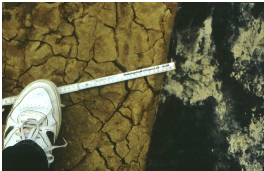
شکل ۲-۱۴- ترک خوردگی در لاینر رسی متراکم‌شده در اثر خشک شدن در زیر ژئوممبرین
