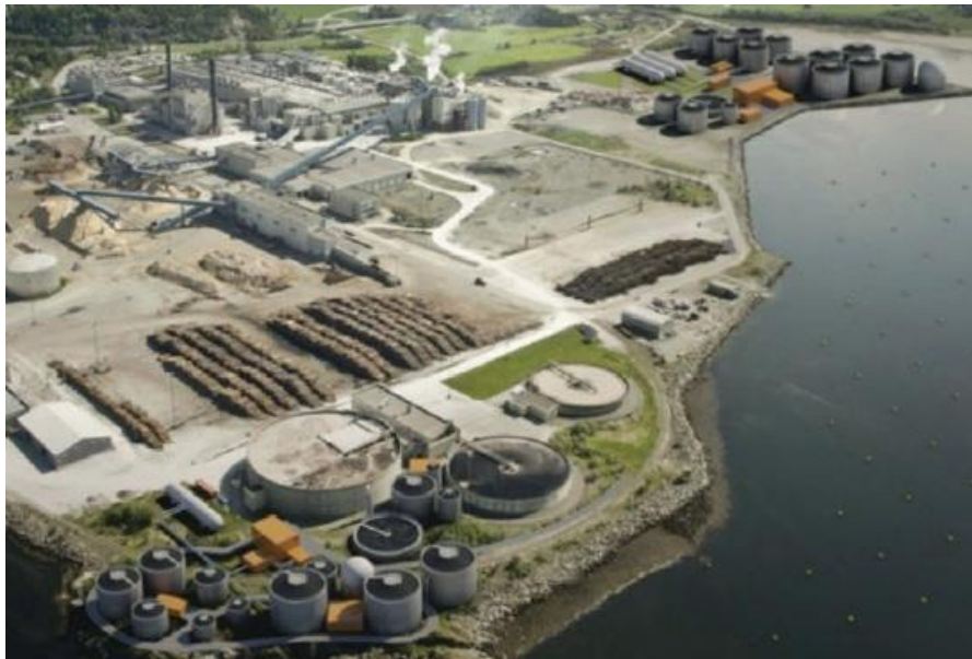
شکل ۳. کارخانه بیوگاز بیوکرافت در Trøndelag در نروژ در بندر و نزدیک به کارخانه خمیر کاغذ Skogn قرار دارد. این کارخانه از محصولات باقیمانده از صنعت خمیر کاغذ و کاغذ و صنعت پرورش ماهی به‌عنوان بستر استفاده می‌کند و دارای ظرفیت تولید حدود ۲۵ میلیون مترمکعب متان مایع برای سوخت خودرو در سال است.
